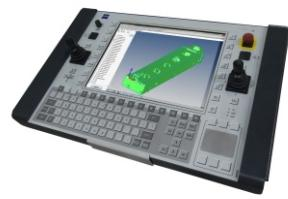
Mit einer Koordinatenmessmaschine Carl Zeiss - MMZG 3000 werden die hochpräzisen Messungen im Bereich von X-3000, Y-6000, Z-2000 mm. Der absolute Längenmessfehler MPEE (Maximum Permissible Error for Length Measurement) beträgt  $3,5+L/400\mu\text{m}$ . Um die Möglichkeiten der Vermessung von großen Teilen zu erhöhen, wurde die Maschine auf 4 Säulen mit einer Höhe von 700mm aufgesetzt, damit wurde der Freiraum bis zum 3200 mm unter dem Portal vergrößert.
