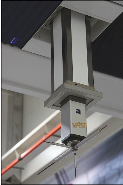
Głowica skanująca ZEISS VAST gold
